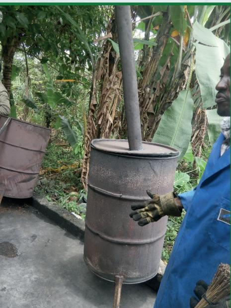
Fig.3. Four à pyrolyse
