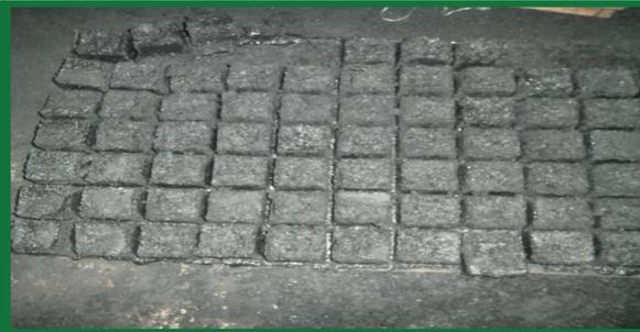
Fig.7. Charbon compacté prêt pour le séchage
